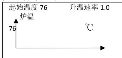
2. 设置起始温度和升温速率：使用“←”使光标处于起始温度处，按数字键盘输入起始温度，
