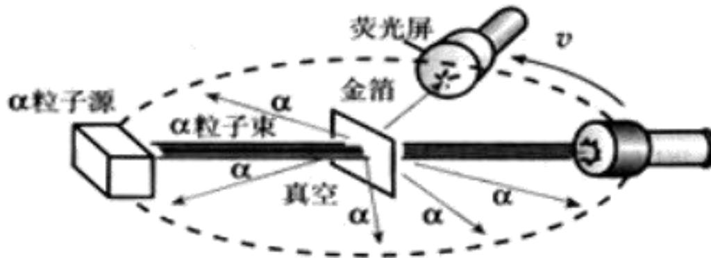
图 20-1  $\alpha$  粒子散射实验的示意图, 荧光屏可以沿着图中虚线转动, 用来统计向不同方向散射的粒子的数目, 实验设备装在真空中。
