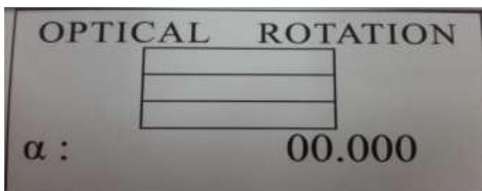
中间可显示 3 组测量数据，下方为实测数值，等 3 组数据测量完毕， $\alpha$  会变为  $\alpha$ ，此时显示的即为 3 组数据的平均值。
